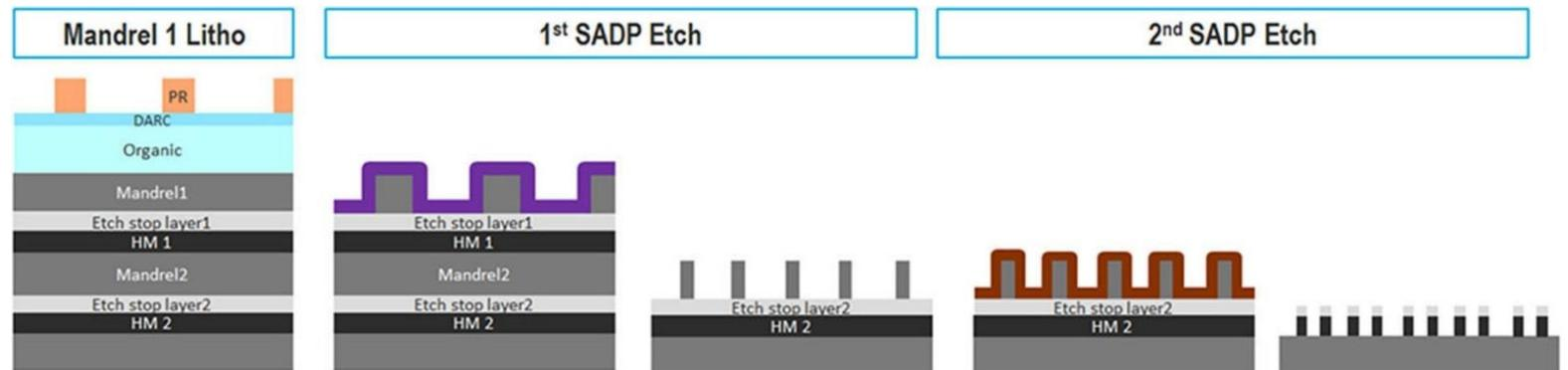
Четырёхпроходная фотолитография по методу SAQP сводится к двум последовательным SADP — только с предварительно нанесёнными на образец двумя жёсткими масками, двумя слоями блокировки травления (etch stop) и двумя слоями для формовки оправок (источник: SPIE)
