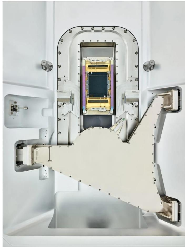
Отражающая фотомаска (тёмно-серый прямоугольник чуть выше центра снимка), смонтированная в держателе внутри EUV-литографа (источник: MIT)
