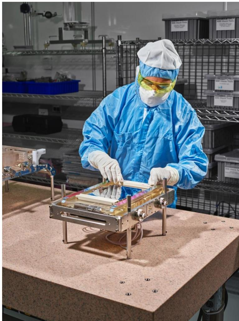
Установка EUV-фотомаски в держатель: ручная работа! (источник: MIT)
